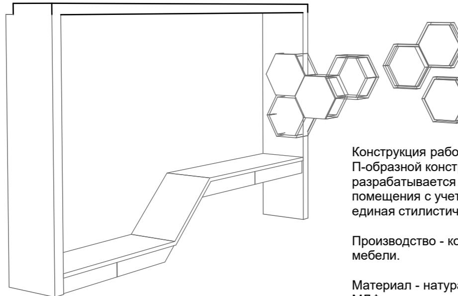
Конструкция рабочего стола-подиума, П-образной конструкции и полок-сот разрабатывается по фактическому замеру помещения с учетом размеров на эскизе, как единая стилистическая конструкция.
