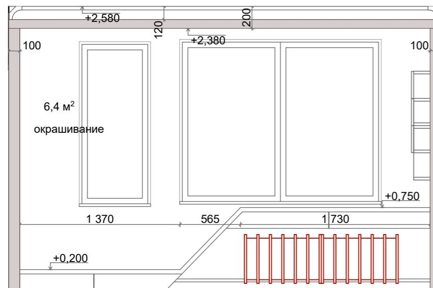
Сначала выстраиваются перегородки согласно плану перегородок. Вокруг перегородок монтируется ниша из ГКЛ согласно обозначенным размерам.
