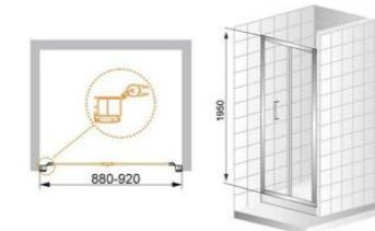
Габариты с регулировками, мм
